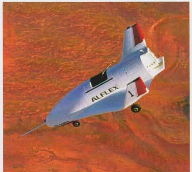
小型自動着陸実験 (ALFLEX) 実験機「アルフレックス」 (1996年7~8月オーストラリアにて実験実施) Automatic Landing Flight Experiment (ALFLEX) Vehicle (Experiment was Conducted between July to August, 1996 in Australia)
