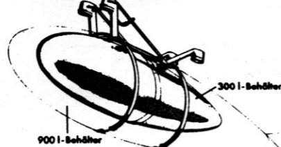
Rüstsatz 24: Rechtes Gerüst
