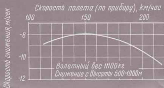
Зависимость скорости снижения от скорости полета в режиме самовращения несущего винта
